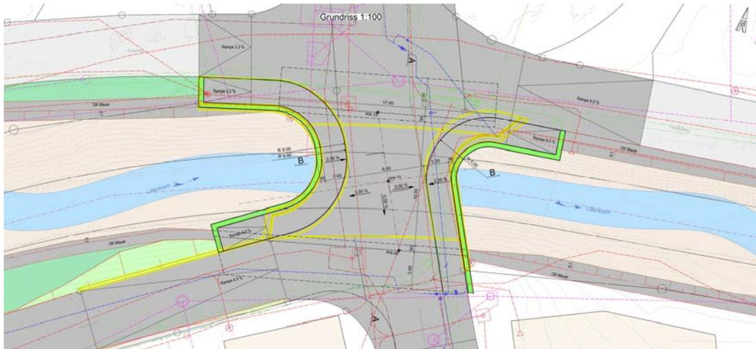
Abbildung 3-22: Horizontale Linienführung Brücke Walzenhauserstrasse, Littenbach
