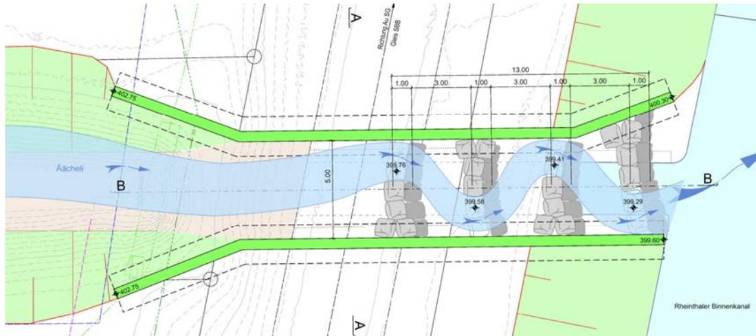
Abbildung 3-7: Pendelrampe am Durchlass SBB, Äächeli
